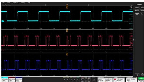
4. チャンネル・バッジをダブルタップしてそのチャンネルのコンフィグレーション・メニューを開き、設定の確認や変更を行います。[チャンネル設定または波形設定の構成](#)(42 ページ)を参照してください。
