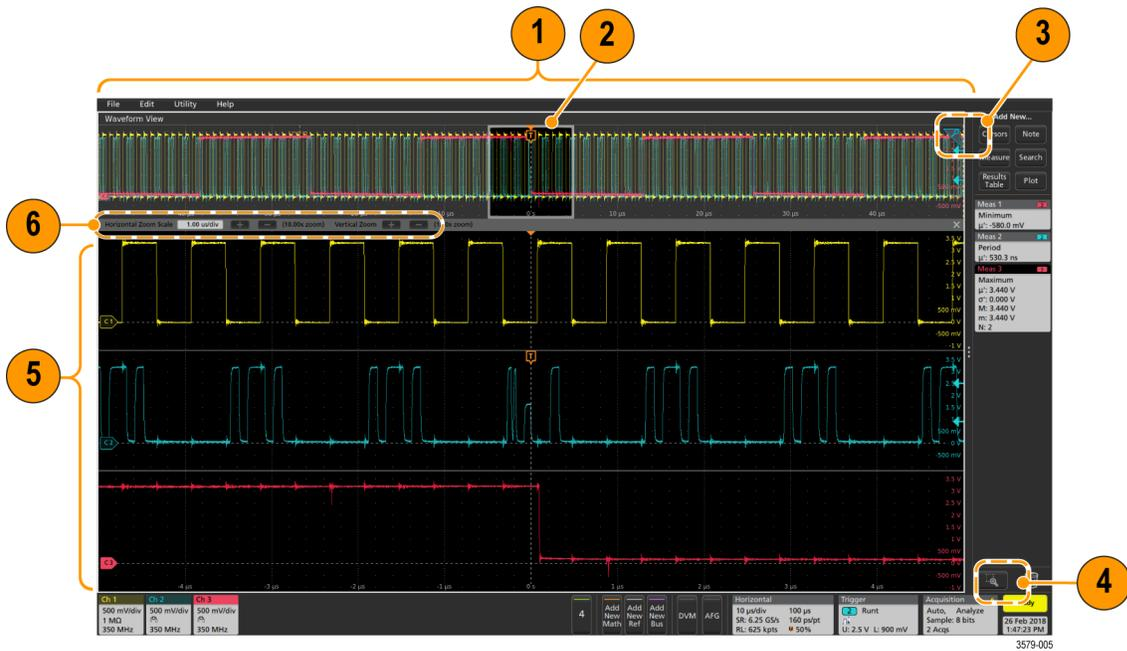
1. **Zoom Overview** (缩放概述) 显示整个波形记录。所有波形在缩放概述区域中以叠加模式显示。
