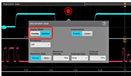
2. **Display Mode** (ディスプレイ・モード) のボタンをタップして **Overlay** (オーバーレイ) モードか **Stacked** (スタック) モードに切り替えます。
