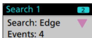
検索バッジを作成するには **Add New...** (新規追加...) **Search** (検索の新規追加) ボタンをタップします。表示されたコンフィグレーション・メニューを利用して検索基準を設定します。
