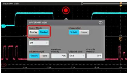
2. 点击 **Display Mode**（显示模式）中的按钮在 **Overlay**（叠加）和 **Stacked**（堆叠）模式之间切换。
