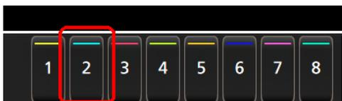
選択したチャンネルが波形表示に追加され、チャンネル・バッジが設定バー(Settings Bar)に追加されます。
