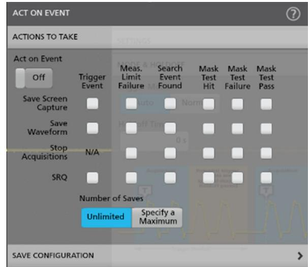
Un osciloscopio se puede automatizar mediante la función para actuación ante un evento determinado.
