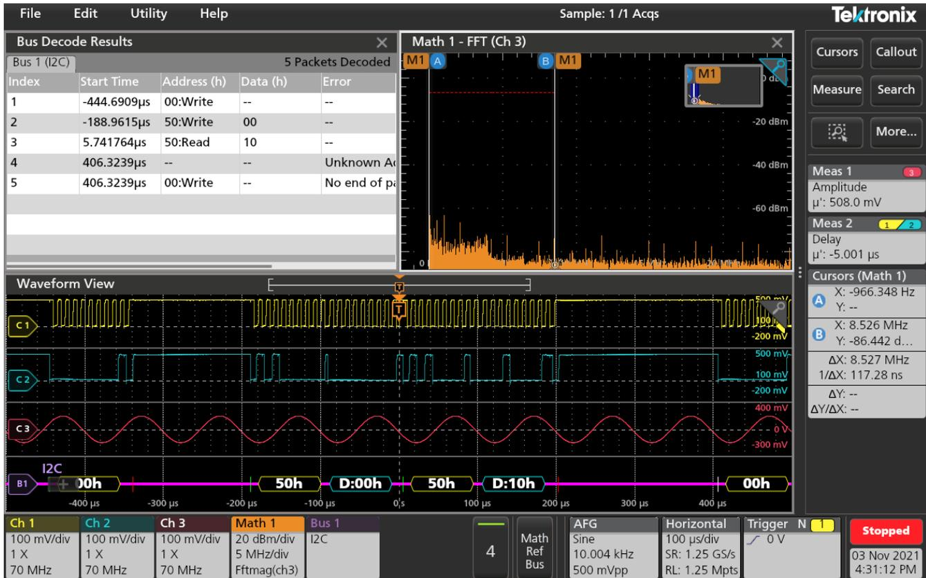
Visualice simultáneamente canales analógicos, forma de onda de bus serie descodificada, tabla de resultados, resultados de medición, gráfico FFT matemático y lecturas de cursor junto con la información de configuración de cada entrada con la interfaz de usuario altamente personalizable.
