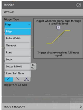
Para acceder a los menús de configuración, basta con tocar dos veces el elemento de interés. En este caso, se ha tocado el icono del disparador para abrir el menú del disparador.
