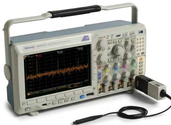
El adaptador opcional TPA-N-VPI permite que se pueda conectar cualquier punta activa de 50 Ω TekVPI a la entrada de RF.
