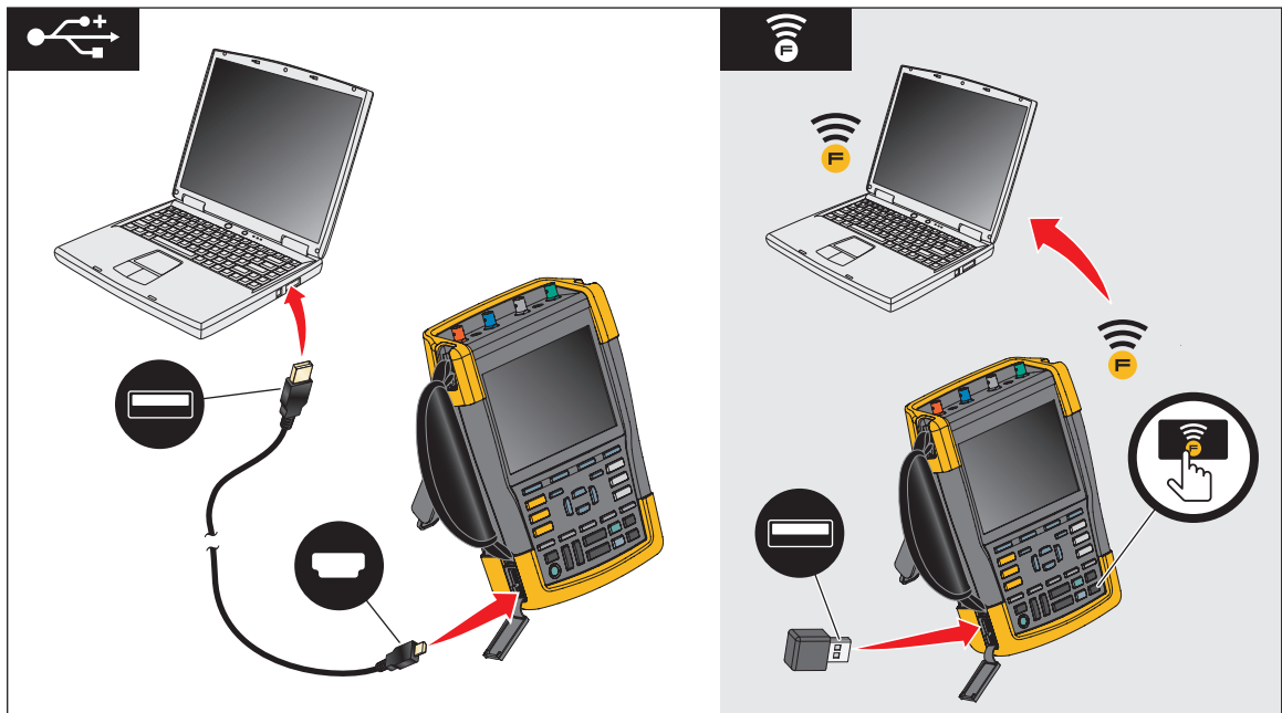
Figura 32. Conexión al ordenador
