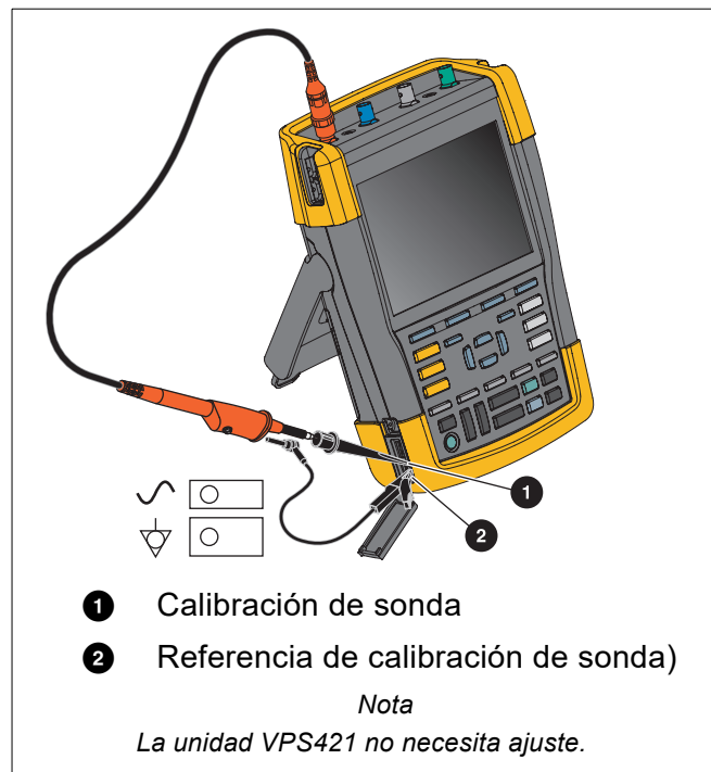
Figura 48. Ajuste de la sonda de tensión
