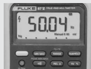
Figura 4. Frecuencia de salida (velocidad del motor) con el filtro paso bajo.
