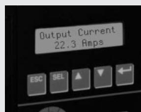
Figura 5. Lectura de corriente de salida sin utilizar el filtro paso bajo.
