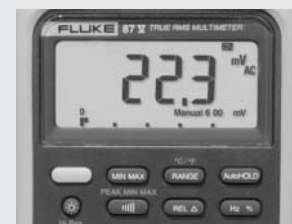
Figura 6. Lectura de corriente de salida con el filtro paso bajo activado.
