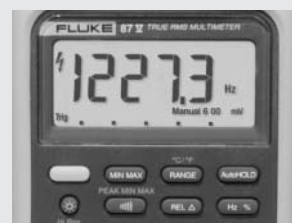
Figura 3. Frecuencia de salida (velocidad del motor) sin el filtro paso bajo.
