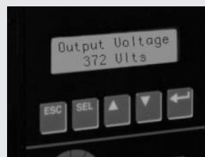
Figura 2. Lectura de tensión de salida con el filtro paso bajo activado.
