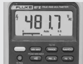
Figura 1. Lectura de tensión de salida sin utilizar el filtro paso bajo.
