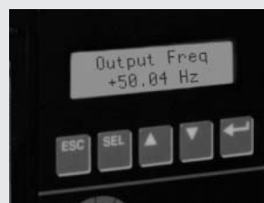
Figura 4. Frecuencia de salida (velocidad del motor) con el filtro paso bajo.
