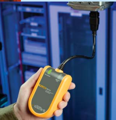
Registrador de perturbaciones eléctricas
