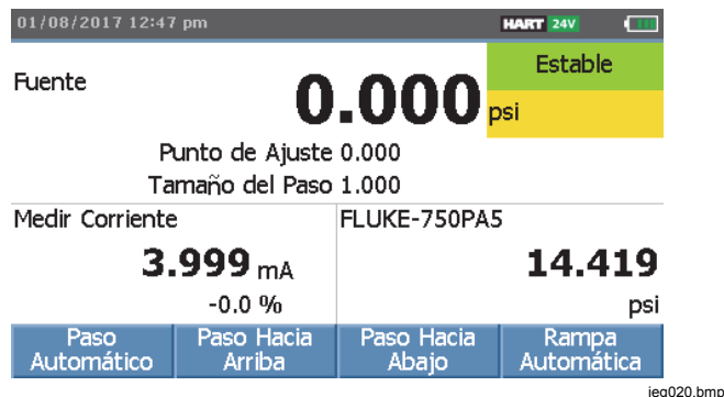
Figura 6. Pantalla de función triple con módulo de presión externo conectado
