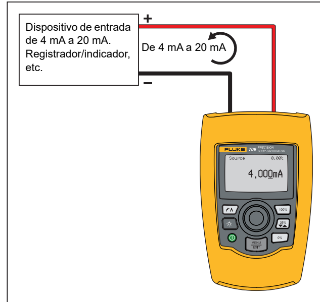
Figura 4. Conexiones de mA Source (Fuente de mA)
