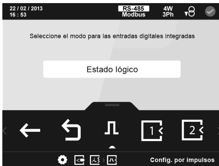
Figura 129: Pantalla principal de la configuración de las entradas digitales de relé.
