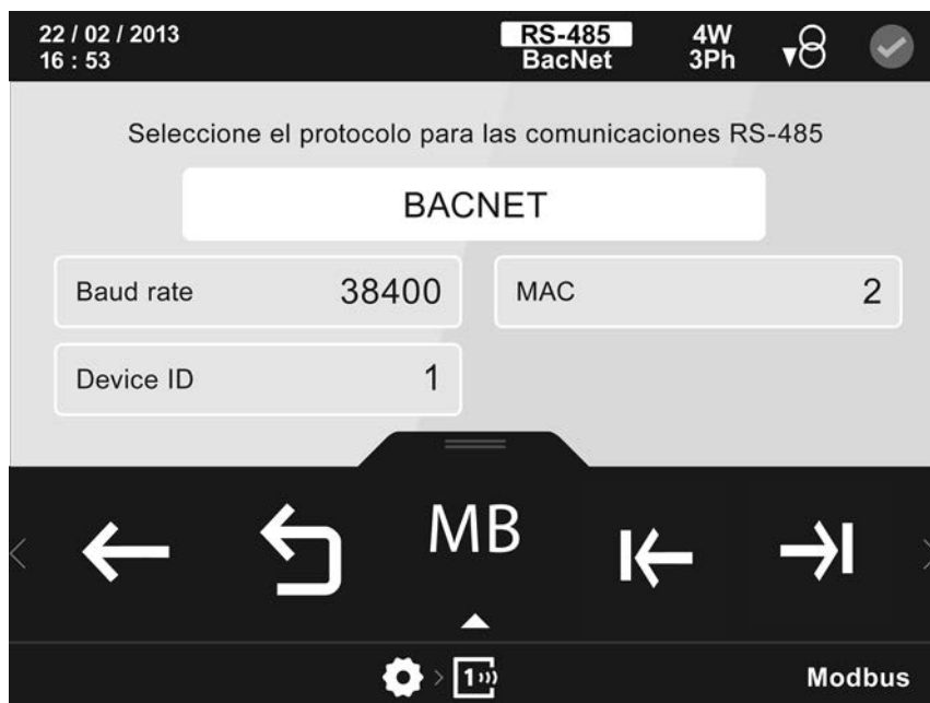
Figura 107: Pantalla de configuración de las comunicaciones integradas ( protocolo BACnet).
