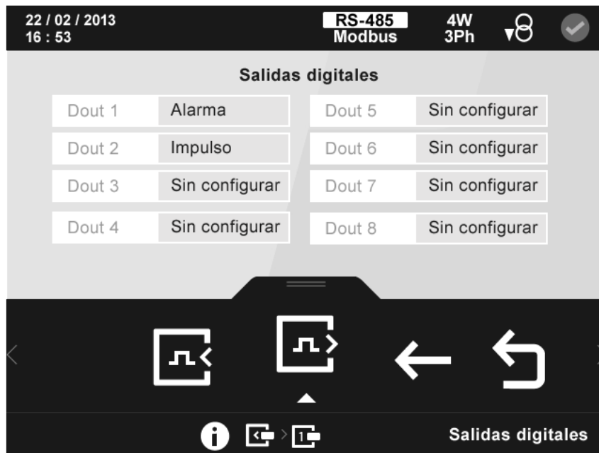
Figura 76: Pantalla de información de las salidas digitales (Módulo Entradas/Salidas digitales de Transistor)
