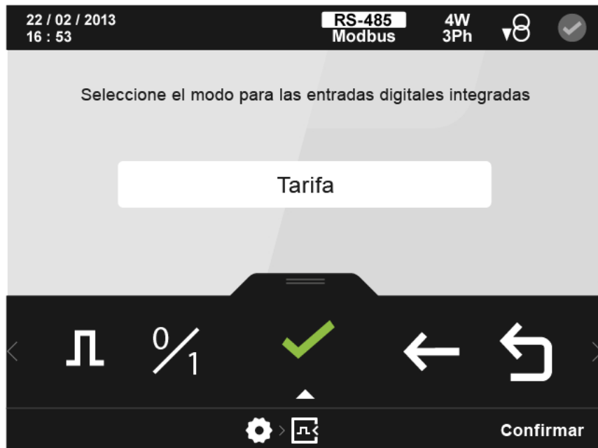
Figura 103: Pantalla de configuración de las entradas digitales ( modo tarifa).
