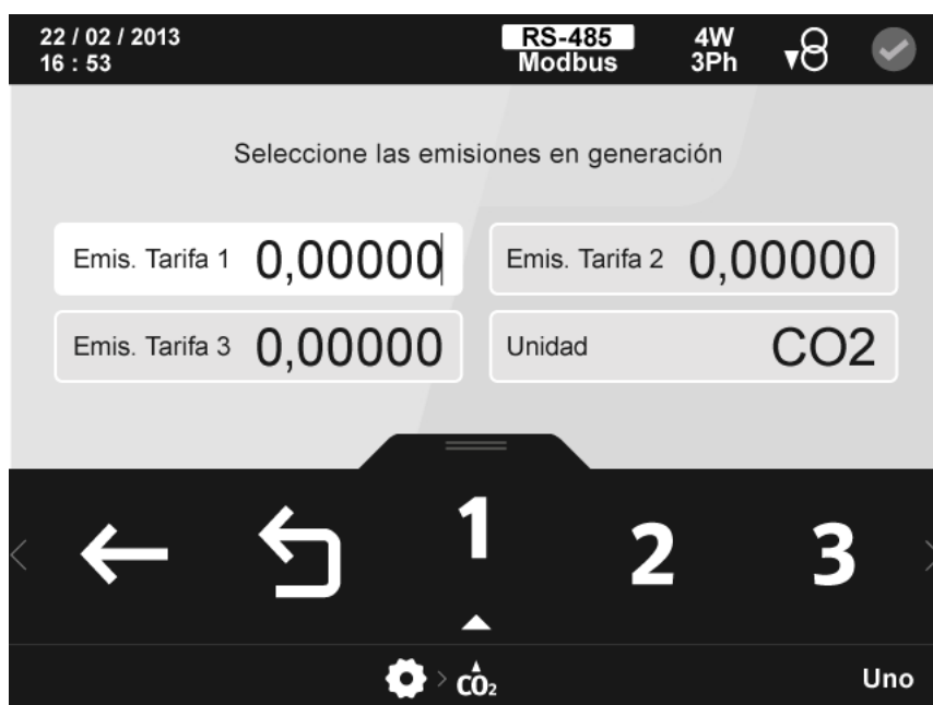
Figura 96: Pantalla de configuración de las emisiones de CO 2 en generación.
