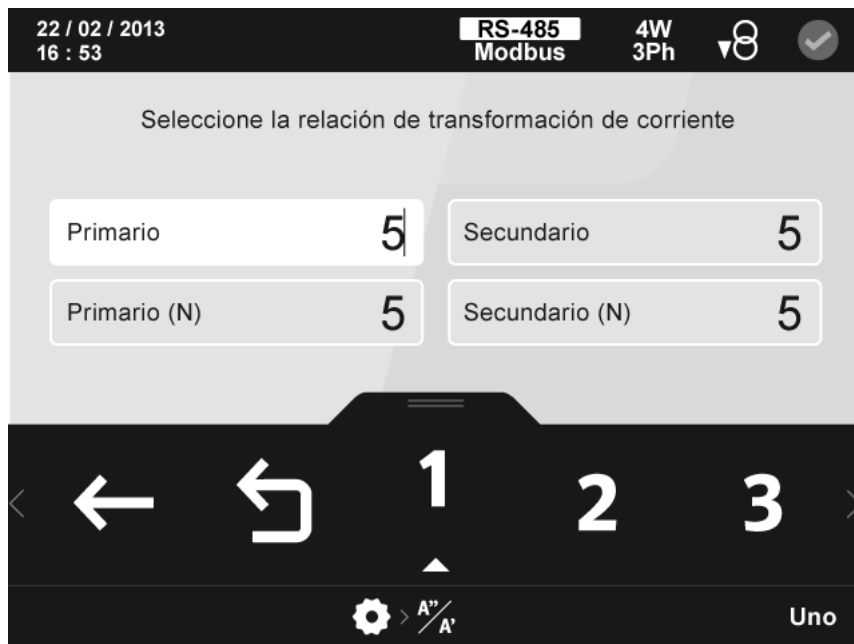
Figura 89: Pantalla de configuración de la relación de los transformadores de corriente.
