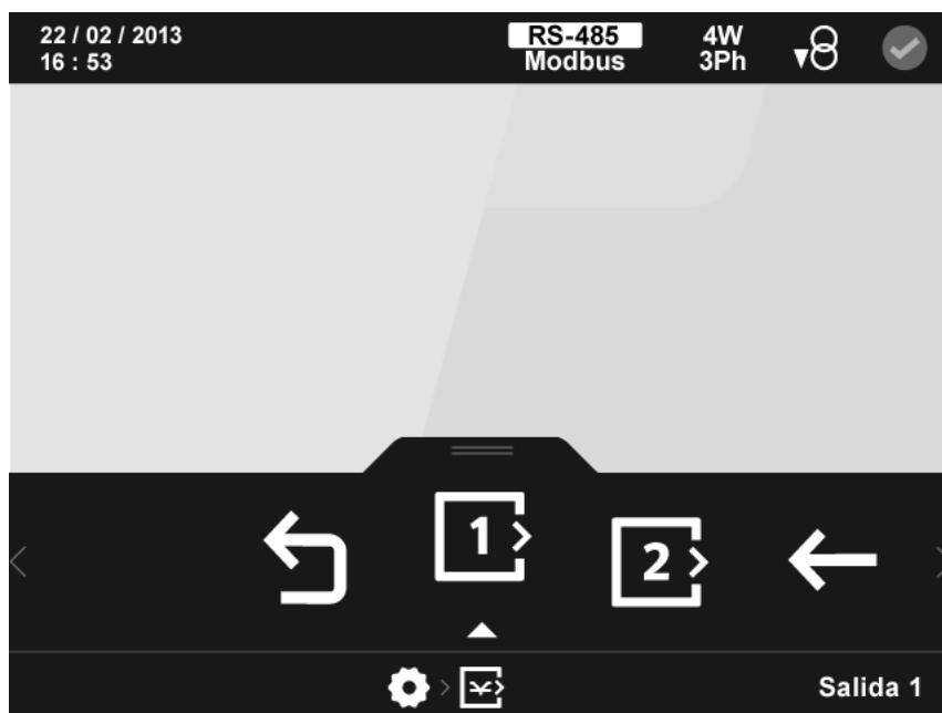
Figura 99: Pantalla principal de la configuración de las salidas digitales de transistor.
