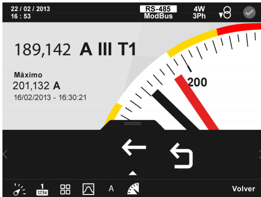
Figura 39: Parámetros de demanda, visualización analógica ( visualizar 1 parámetro).
