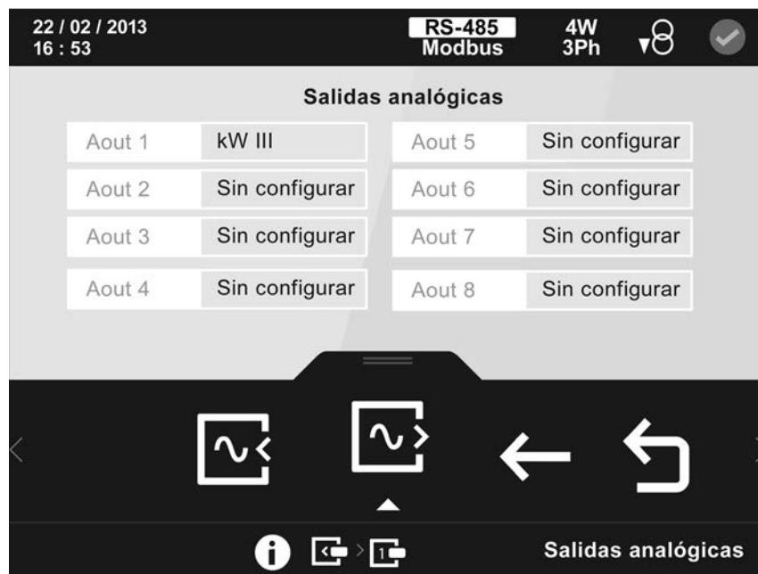
Figura 78: Pantalla de información de las salidas analógicas (Módulo Entradas/Salidas Analógicas)
