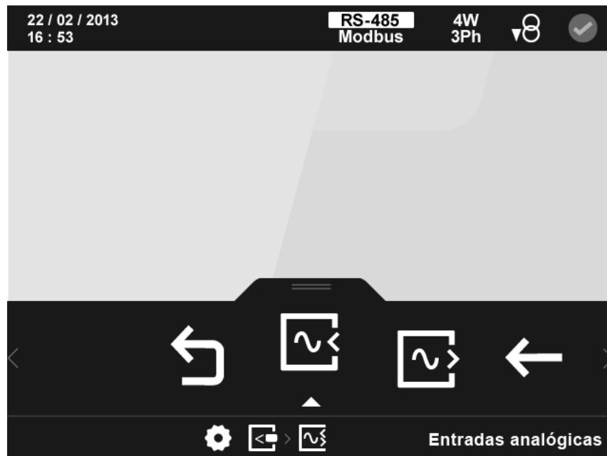
Figura 133: Pantalla principal de la configuración de las Entradas/Salidas analógicas.
