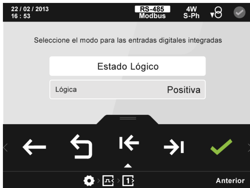
Figura 105: Pantalla de configuración de las entradas digitales ( modo estado lógico).
