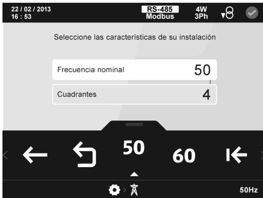
Figura 92: Pantalla de configuración de las características de la instalación.
