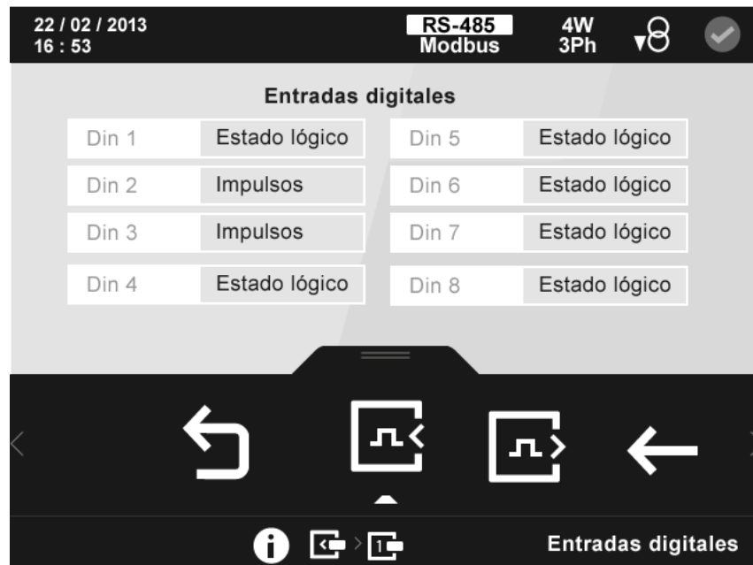
Figura 75: Pantalla de información de las entradas digitales (Módulo Entradas/Salidas digitales de Transistor).
