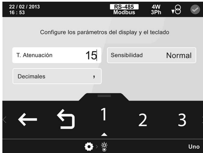
Figura 109: Pantalla de interficie de usuario.
