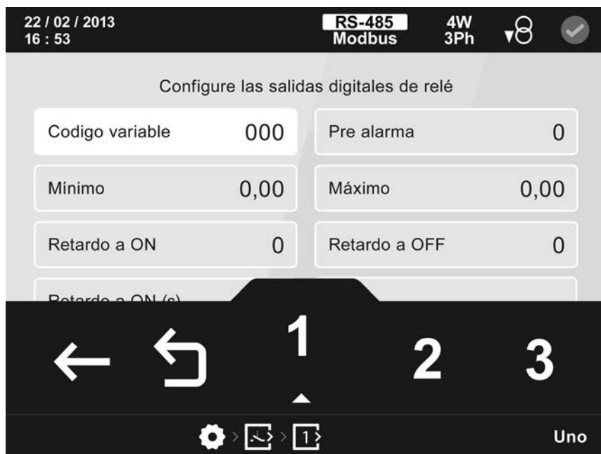
Figura 98: Pantalla de configuración de las salidas digitales de relé.
