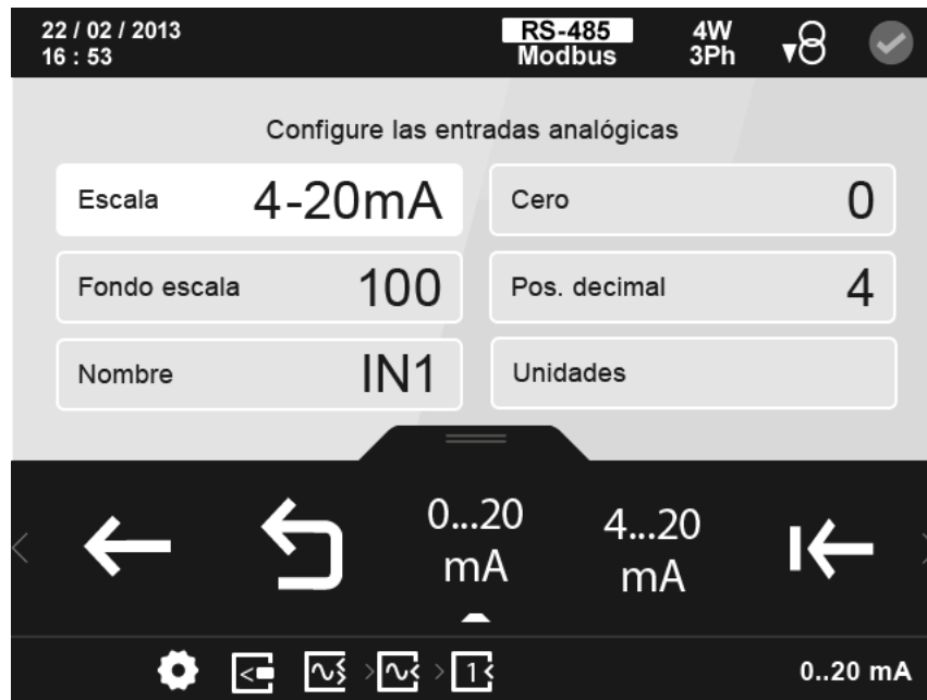
Figura 135: Pantalla de configuración de las entradas analógicas.
