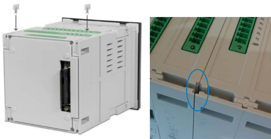
Figura 113: Introducir los clips de sujeción en las ranuras correspondientes.
