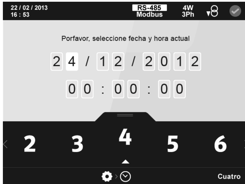
Figura 83: Pantalla de configuración de la fecha y hora.
