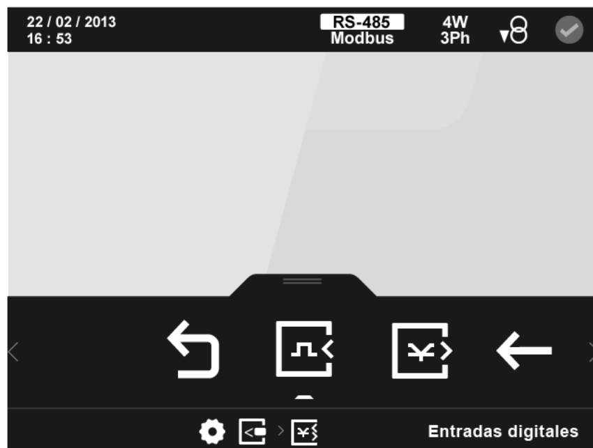
Figura 131: Pantalla principal de la configuración de las entradas/salidas digitales de transistor.
