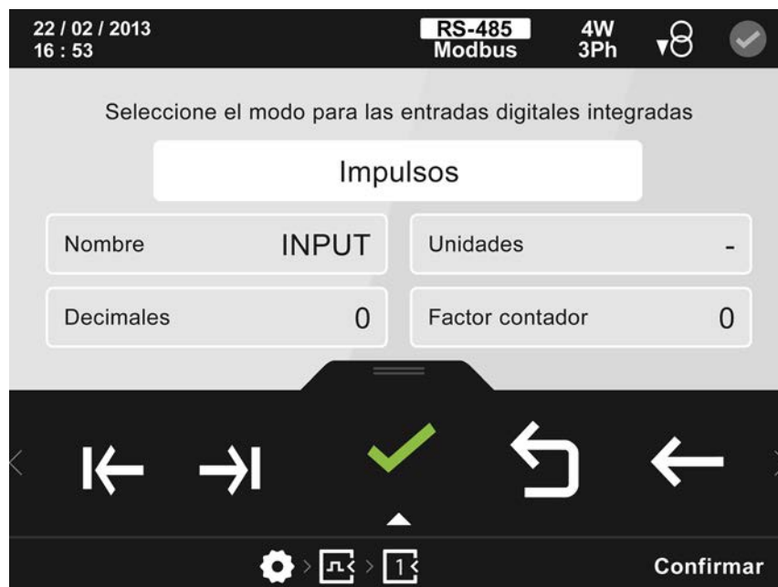
Figura 104: Pantalla de configuración de las entradas digitales ( modo impulsos).
