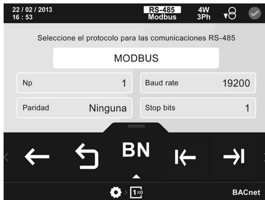
Figura 106: Pantalla de configuración de las comunicaciones integradas ( protocolo Modbus).
