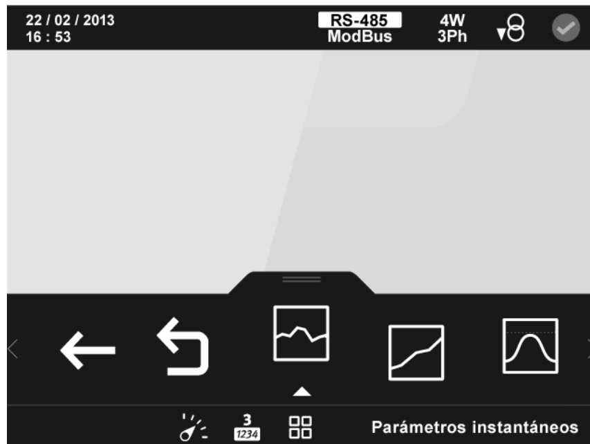
Figura 43: Pantalla de visualización de parámetros por defecto (visualizar 3 parámetros).
