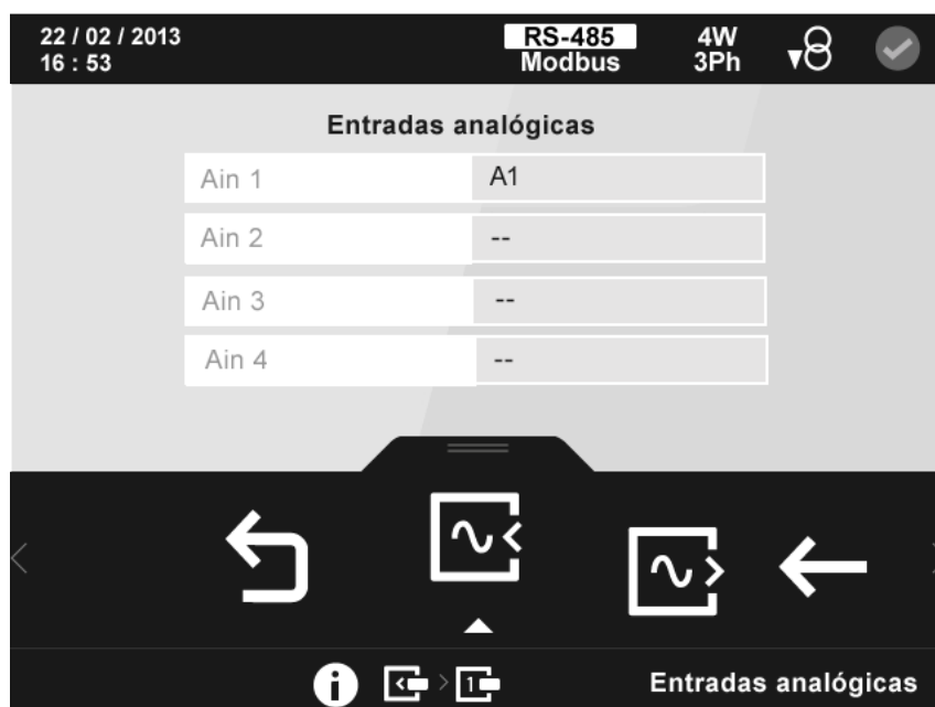
Figura 77: Pantalla de información de las entradas analógicas (Módulo Entradas/Salidas Analógicas).
