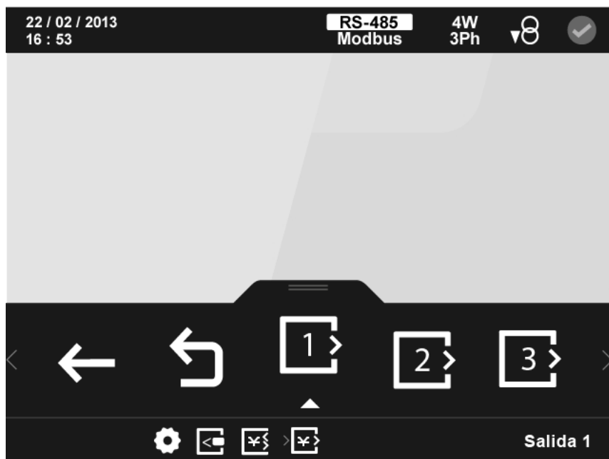
Figura 132: Pantalla principal de la configuración de las salidas digitales de transistor.
