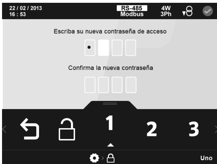
Figura 86: Pantalla de configuración de la clave de acceso.
