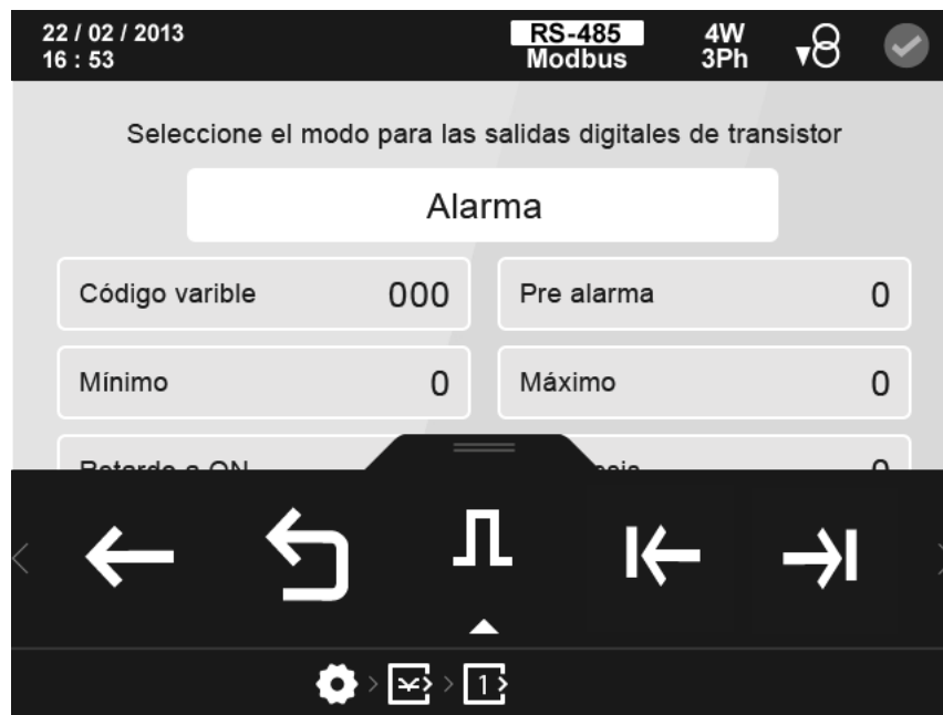
Figura 100: Pantalla de configuración de las salidas digitales de transistor ( modo alarma).
