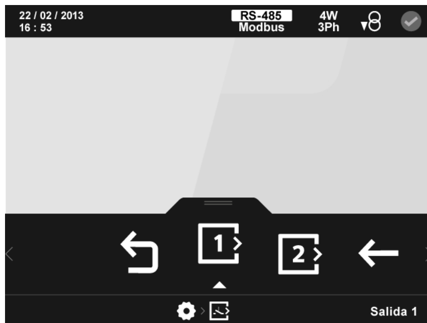
Figura 97: Pantalla principal de la configuración de las salidas digitales de relé.
