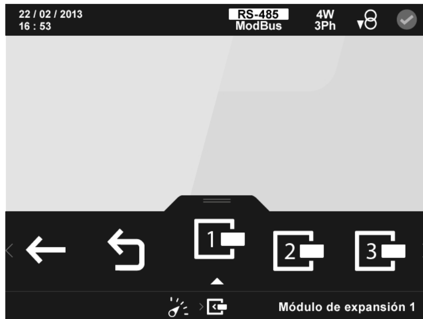
Figura 67: Pantalla de información de los módulos de expansión.
