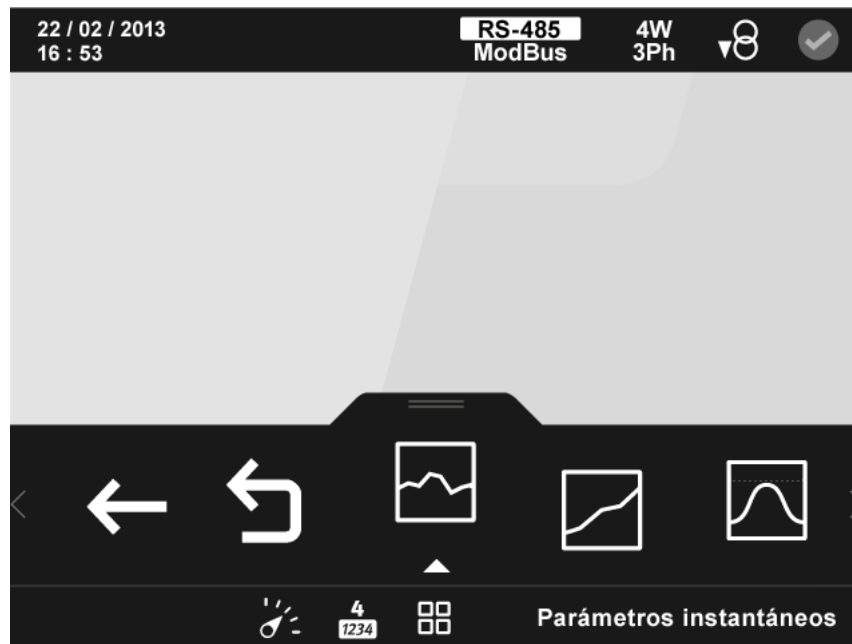
Figura 53: Pantalla de visualización de parámetros por defecto (visualizar 4 parámetros).
