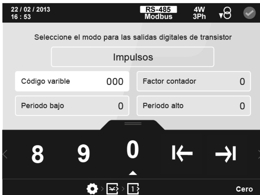
Figura 101: Pantalla de configuración de las salidas digitales de transistor ( modo impulsos).
