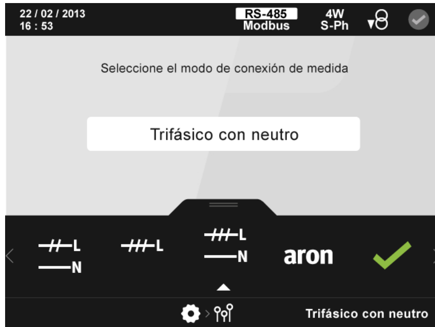
Figura 87: Pantalla de configuración del modo de conexión de la medida.
