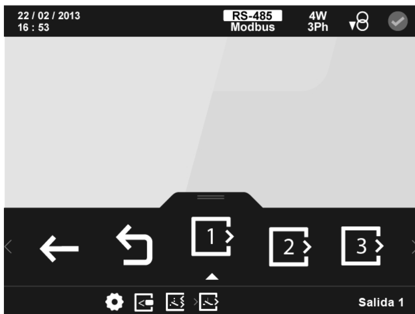
Figura 130: Pantalla principal de la configuración de las salidas digitales de relé.
