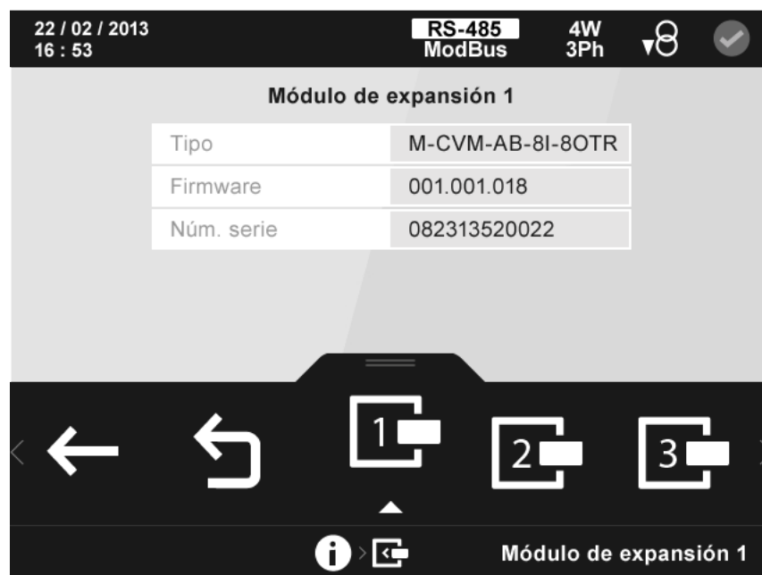
Figura 139:Pantalla de información de los módulos de expansión.
