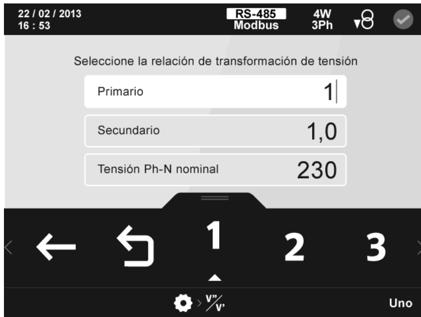
Figura 88: Pantalla de configuración de la relación de los transformadores de tensión.
