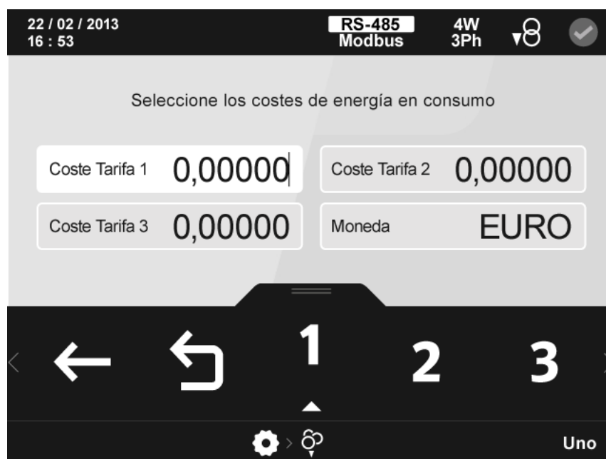
Figura 93: Pantalla de configuración de los costes de energía en consumo.
