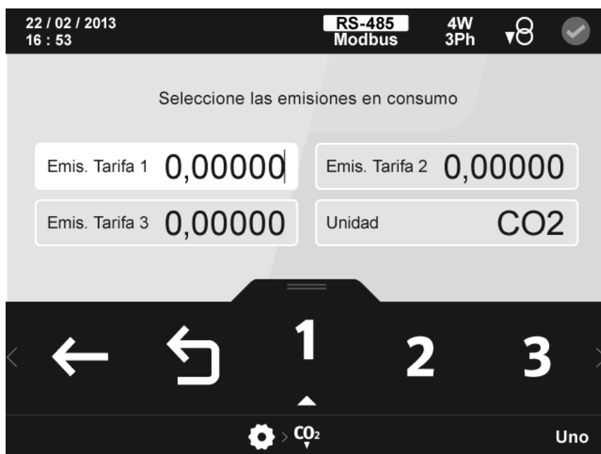
Figura 95: Pantalla de configuración de las emisiones de CO 2 en consumo.
