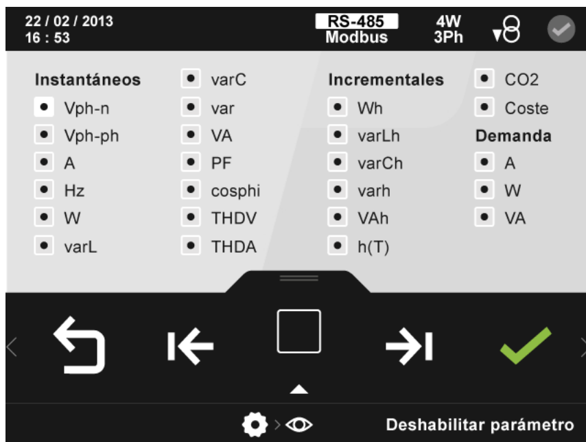
Figura 90: Pantalla de configuración de la visualización de variable.
