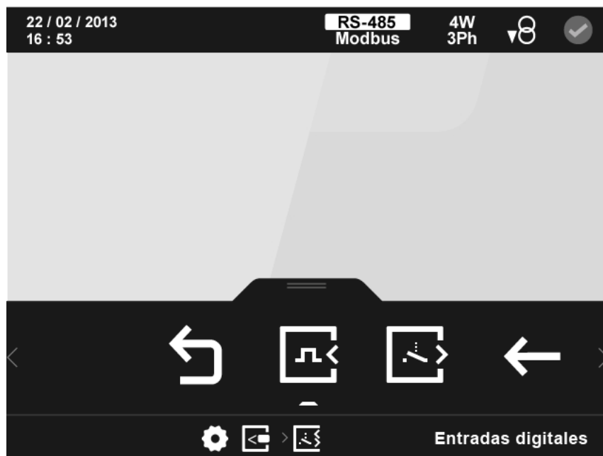
Figura 128: Pantalla principal de la configuración de las entradas/salidas digitales de relé.
