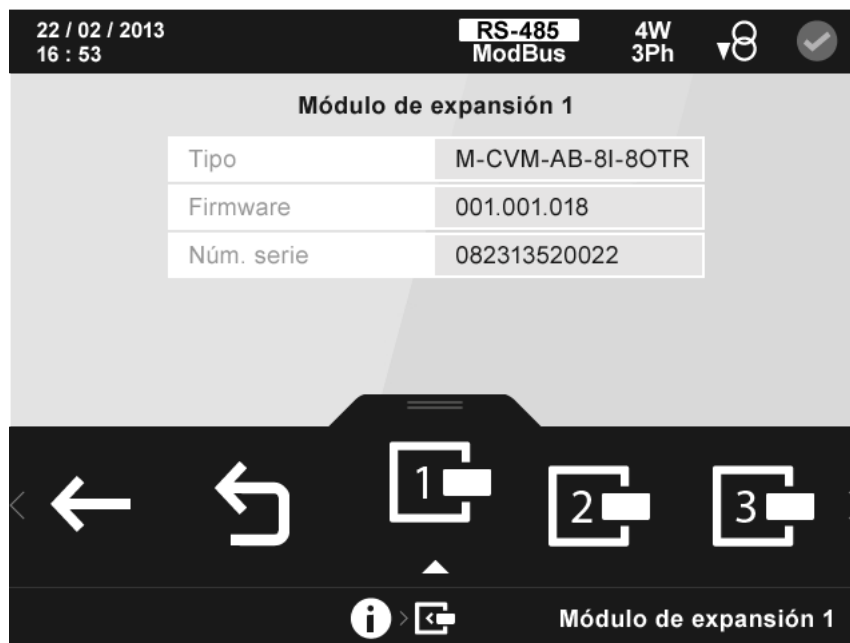
Figura 74: Pantalla de información de los módulos de expansión.
