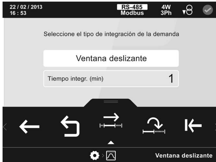
Figura 91: Pantalla de configuración de los parámetros de máxima demanda.
