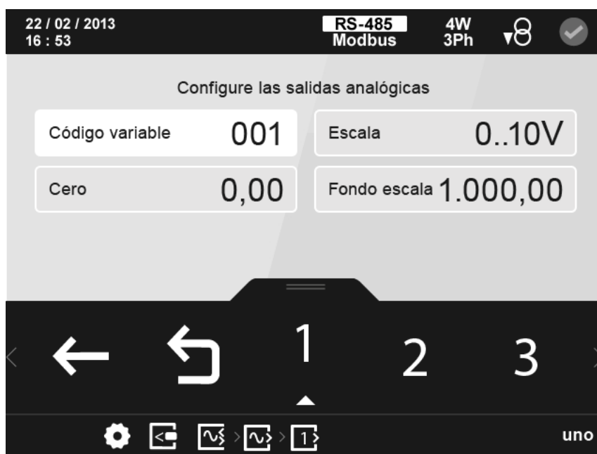
Figura 137: Pantalla de configuración de las salidas analógicas.
