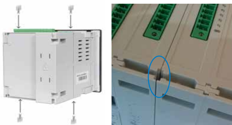
Figura 320: Introducir los clips de sujeción en las ranuras correspondientes.
