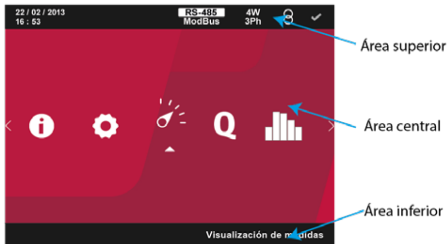
Figura 25: Áreas del display del CVM-A.
