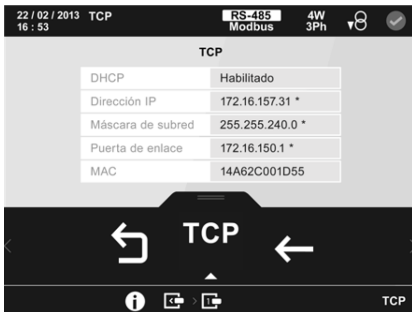
Figura 236: Pantalla de información del módulo Modbus TCP (Switch) (Comunicación TCP).
