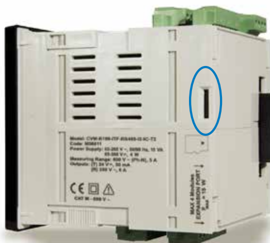
Figura 395: Posición de la ranura con la microSD.
