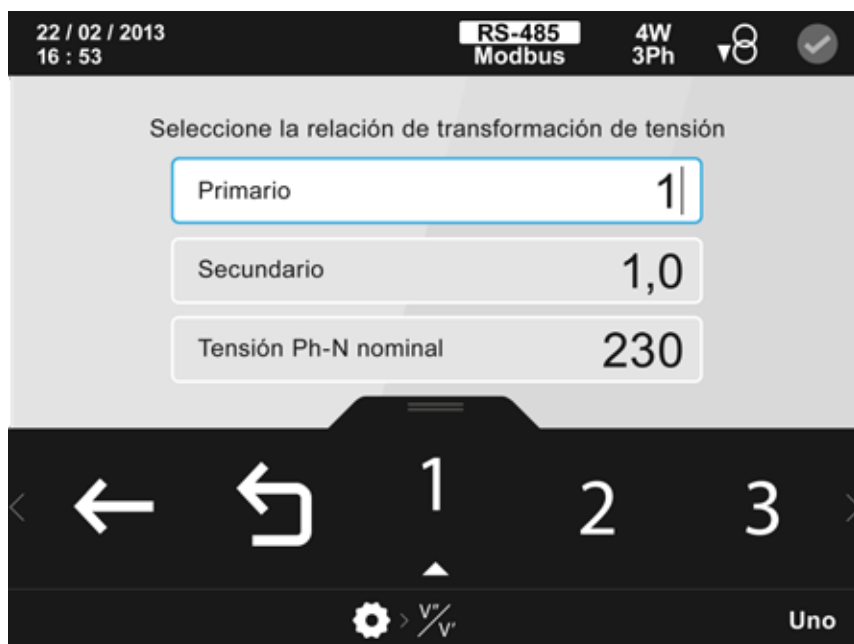
Figura 258: Pantalla de configuración de la relación de los transformadores de tensión.
