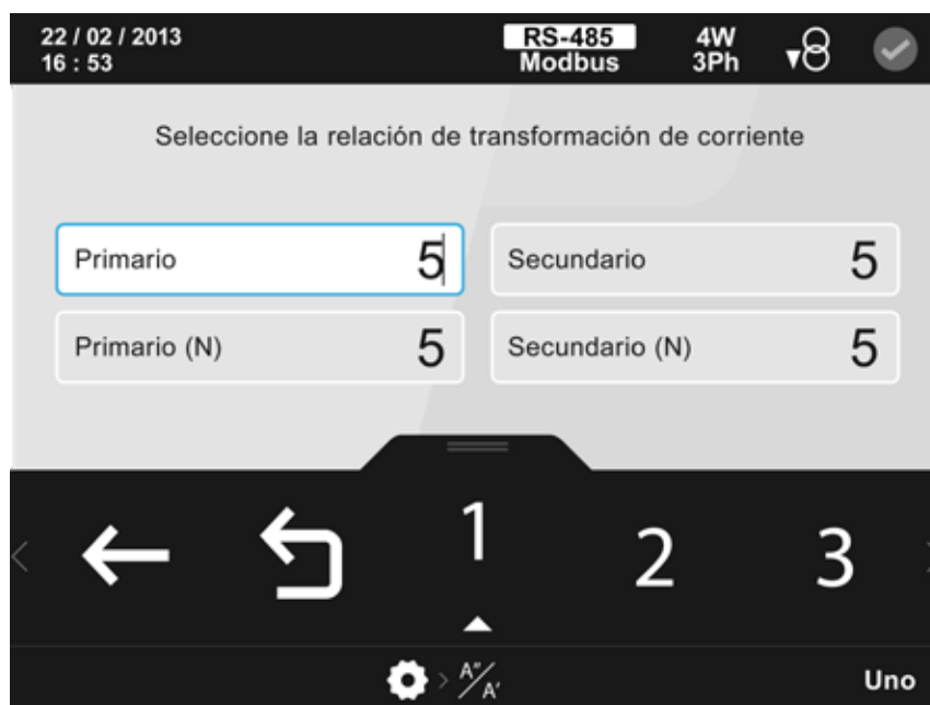
Figura 260: Pantalla de configuración de la relación de los transformadores de corriente.
