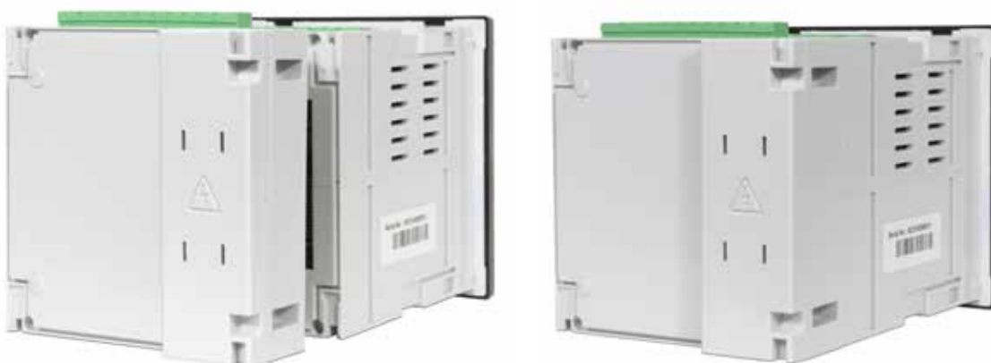
Figura 319: Conectar el módulo de expansión.
