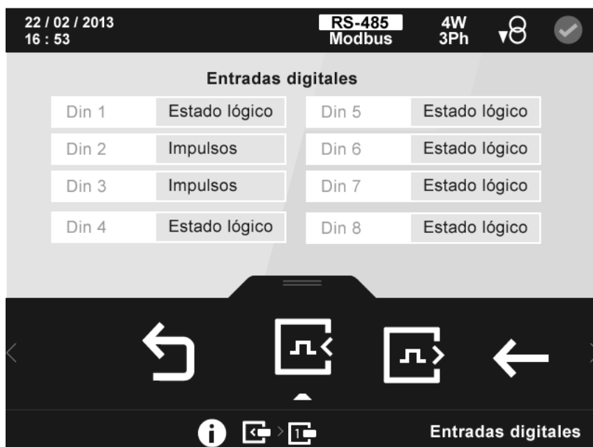
Figura 221: Pantalla de información de las entradas digitales (Módulo Entradas/Salidas digitales de Transistor).
