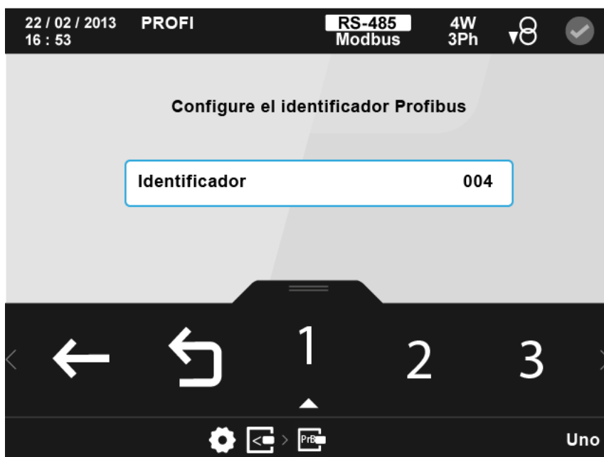
Figura 378: Pantalla principal de configuración del módulo Profibus
