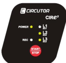
*L1/sc1* **parpadea** indicando mal conexionado de la pinza. En este caso el usuario debe proceder a verificar que la pinza está bien cerrada, conectada respetando el sentido de la corriente de la instalación, según muestra la flecha y que la pinza conectada identificadas con *L1*, *L2* y *L3*, se encuentra instalada en la fase que le corresponde que según los colores de los cables de tensión son **NEGRO**, **ROJO** y **AMARILLO** respectivamente
