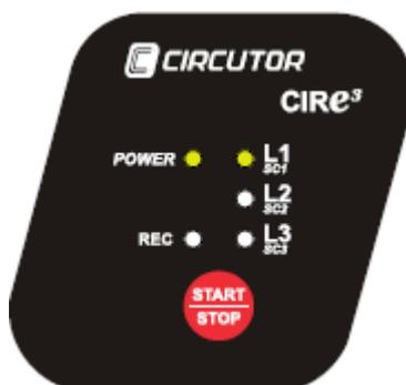
Los led *L1/sc1*, *L2/sc2* y *L3/sc3* deben estar encendidos antes de instalar las pinzas flexibles de corriente en el embarrado o conductor, como muestra la figura.
