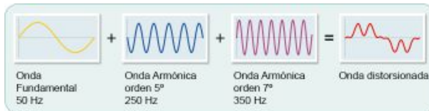
Figura 30: Descomposición de forma de onda distorsionada.
