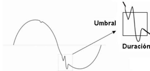
Fig. 10-12.- Defecto en la forma de onda
