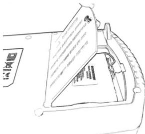
5º Colocar la tapa posterior verificando que no dañamos ninguno de los cables y que la batería queda bien sujeta.
