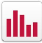
Esta pantalla permite ver el contenido de armónicos de las tensiones y corrientes medidas por el instrumento. Estos datos pueden presentarse en forma de gráfico de barras ( Fig. 16-1) o en forma de tabla
