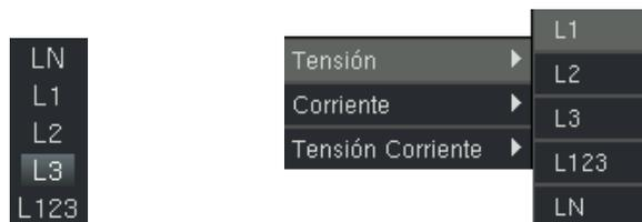
Con los cursores de desplazamiento ◀/ ▶ y ▼/ ▲ se desplaza el cursor de selección hasta la opción de menú deseada. Mediante el botón λ se confirma la selección y se cambia a la pantalla de visualización deseada.
