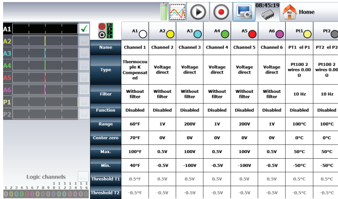
La configuración de los canales muestra todos los parámetros en una sola pantalla.
