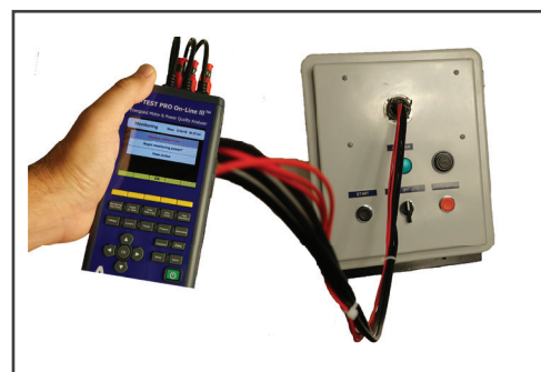
ALL-SAFE instalado dentro de la caja de inicio, conectado a ATPOL III™ para comenzar a tomar lecturas.
