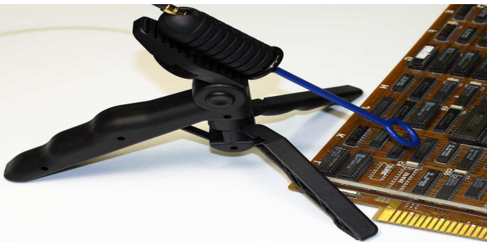
El mini-trípode adjunto a sido usado para fijar la sonda
