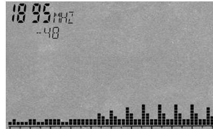
Fácilmente reconocible: el "salto de frecuencias" de un teléfono DECT entre los 1890 y 1900MHz (extracto del gráfico)
