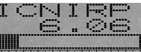
El SPECTRAN® indica el porcentaje alcanzado de un valor límite con un número decimal y lo representa gráficamente con una barra
