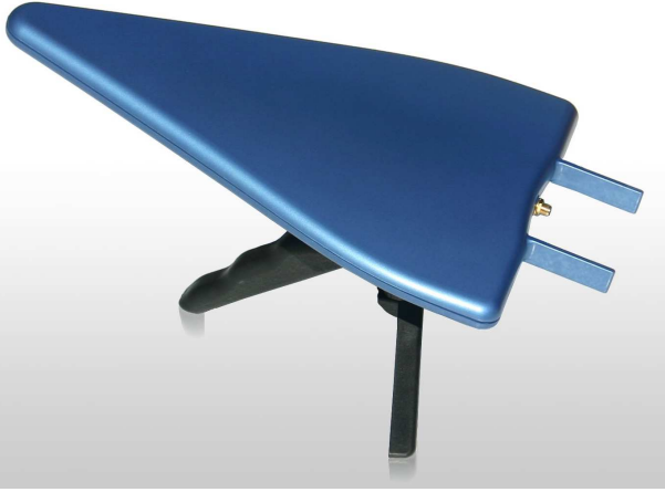
Antena HyperLOG 60xxx con el mango tipo pistola desplegado
